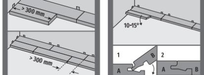
13. Начинайте монтаж первого ряда с левого угла помещения. Установите распорные клинья между стеной и краями панелей. Расположите несколько панелей в ряд по длине помещения так, чтобы стороны с пазами были обращены к укладчику. Край панели, обращенные к стене, следует обрезать так, чтобы убрать замковый элемент.
